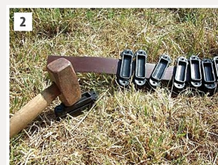
Sluit de houders en schuif ze over de band.
